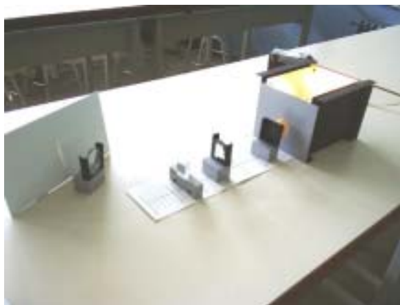
El muntatge complet amb el prisma i les lents correctores
