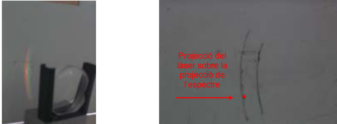
Projecció de l'espectre lluminós i del raig làser sobre la pantalla blanca Figura 9.10
